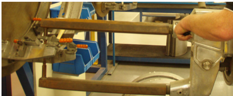
Figura 7.2 — Saldatrice a punti portatile sospesa
