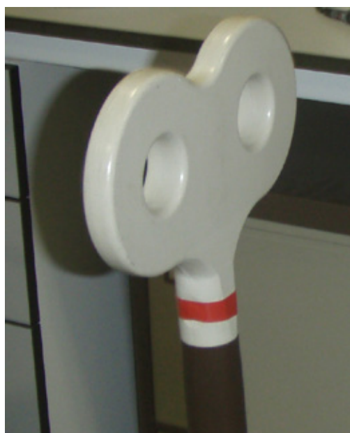
Figura 4.2 — Bobina TMS a forma di otto
